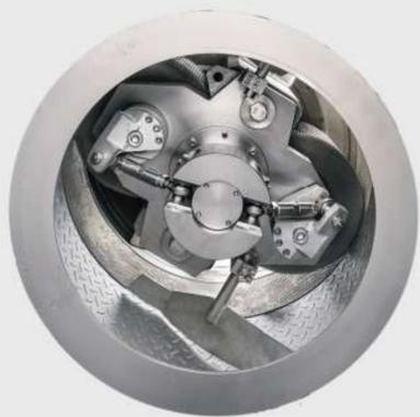
Ajuste automático de los rodillos y control de deslizamiento de rodillos disponible
